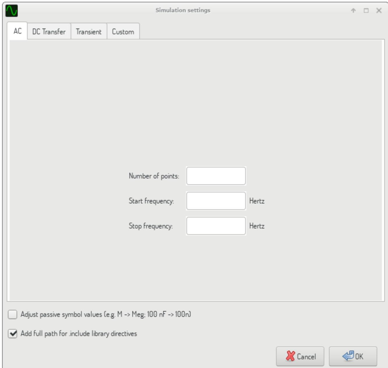
模拟设置对话框允许用户设置模拟类型和参数。有四个选项卡：
