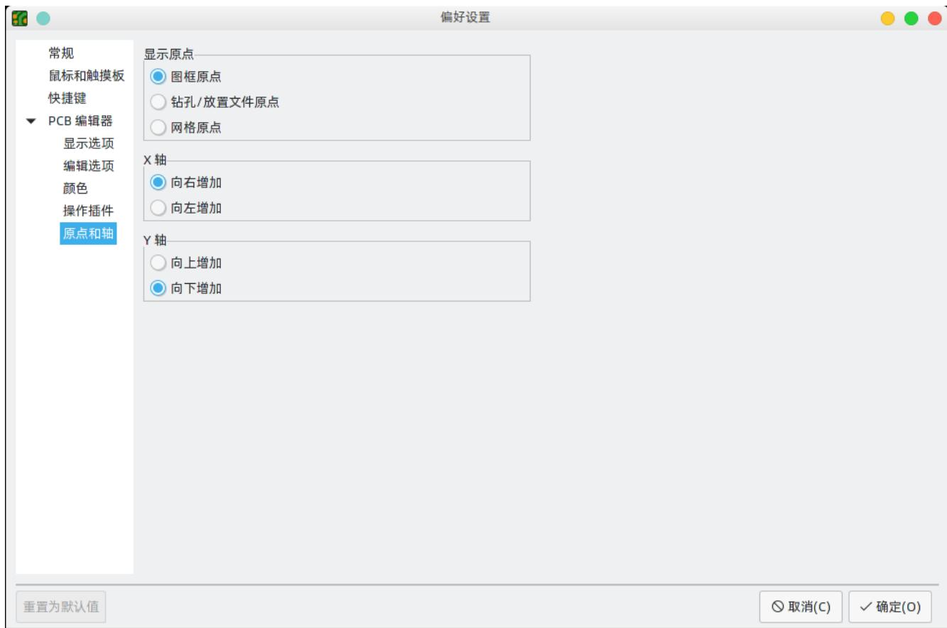
**显示原点**：决定在编辑画布中坐标显示使用哪个坐标原点。页面原点固定在页面的角落。用户可以移动钻取/放置文件原点和栅格原点。
