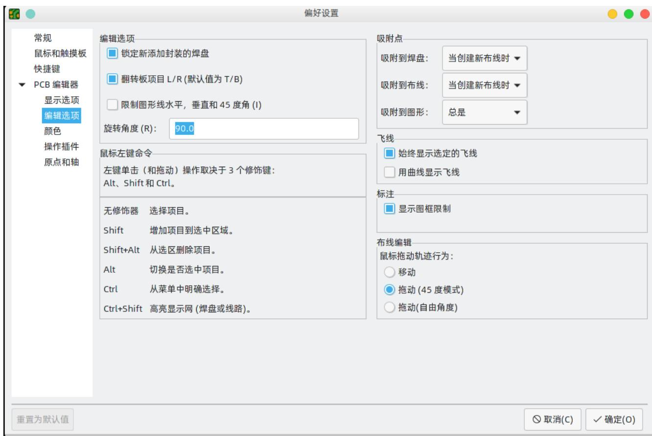
**翻转电路板项目 L/R**：控制在顶层和底层之间移动电路板项目时翻转的方向。选中时，项目从左向右翻转(围绕垂直轴)；取消选中时，项目从上向下翻转(围绕水平轴)。
