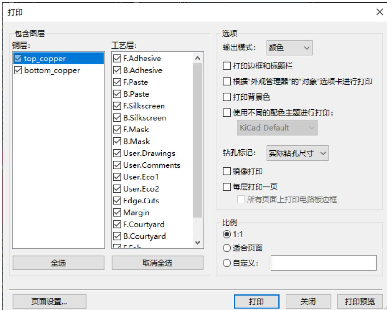
**包含层：**选择要包含在打印输出中的层。未选中的层将不可见。
