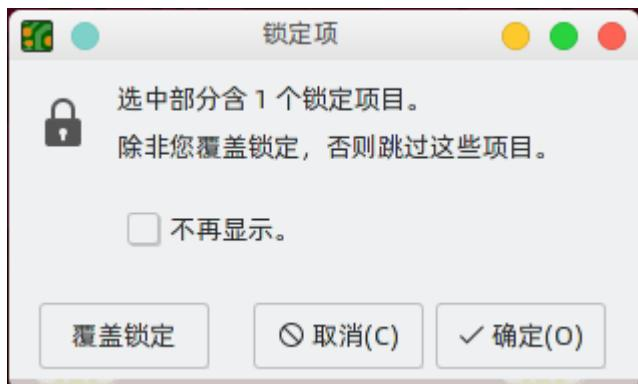
在这个对话框中选择 "覆盖锁定" 将允许移动锁定的项目。选择 "确定" 将允许你在选择中移动任何未上锁的项目；留下锁定的项目。选择 "不再显示" 将使你在剩下的会话中记住你的选择。
