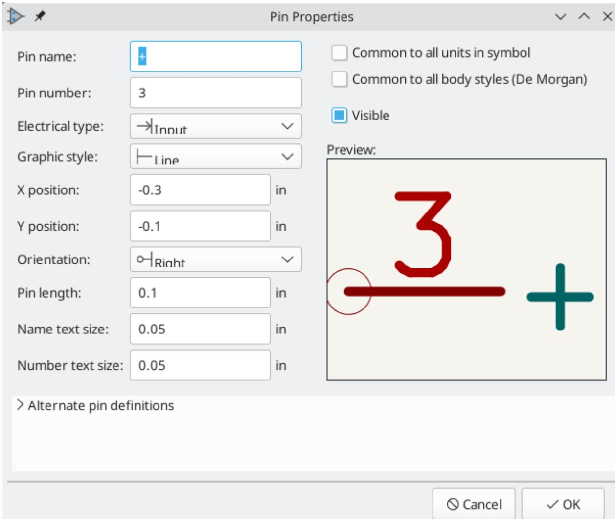
引脚属性对话框允许您编辑引脚的所有特性。创建引脚或双击现有引脚时，会自动弹出此对话框。此对话框允许您修改：
