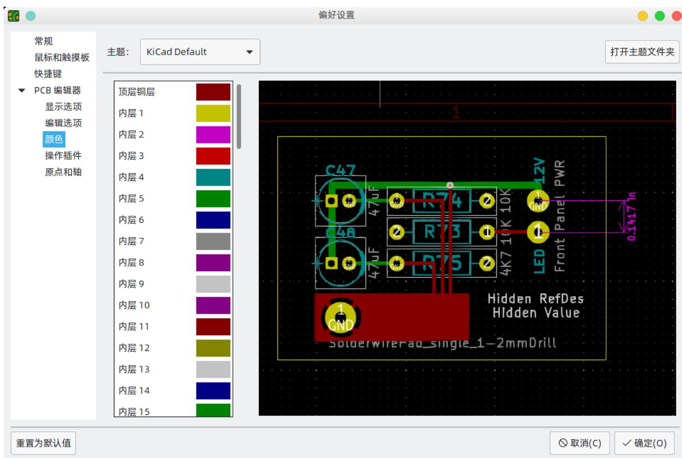
Pcbnew 支持在不同的颜色主题之间切换，以符合您的喜好。KiCad 6.0 有两个内置的颜色主题：“KiCad 默认”是一个新主题，设计用于大多数情况下具有良好的对比度和平衡度，并且是新安装的默认主题。“KiCad 经典版”是 KiCad 5.1 及更早版本的默认主题。这两个内置主题都不能修改，但您可以创建新主题来自定义 Pcbnew 的外观，也可以安装其他用户制作的主题。
