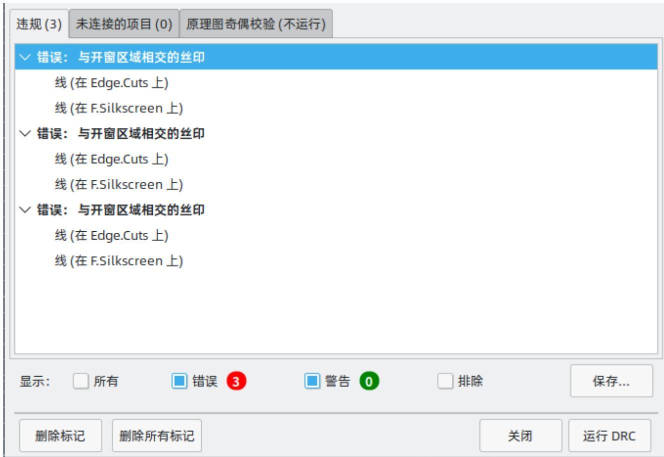
每项违规行为涉及 PCB 上的一个或多个对象。在违章列表中，涉及的对象列在违章下面。点击列表中的违规行为将移动 PCB 编辑器的视图，使受影响的区域居中。点击违章所涉及的对象之一将突出显示该对象。
