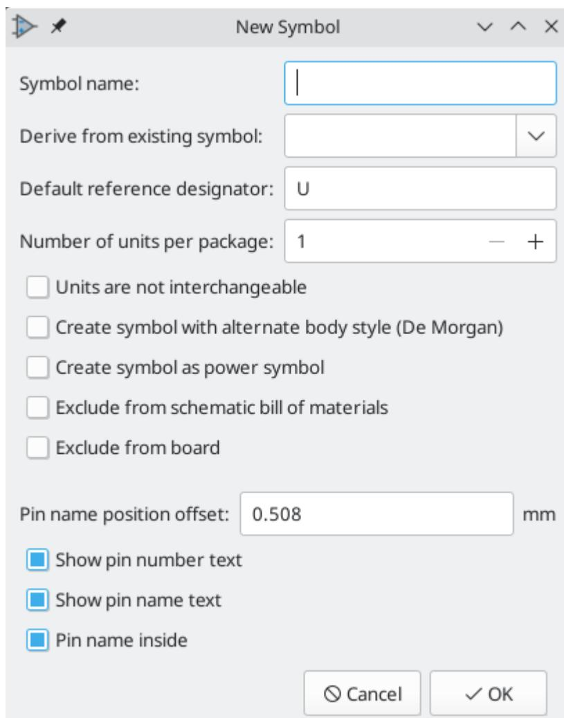
将使用上面的属性创建一个新符号，它将出现在编辑器中，如下所示。
