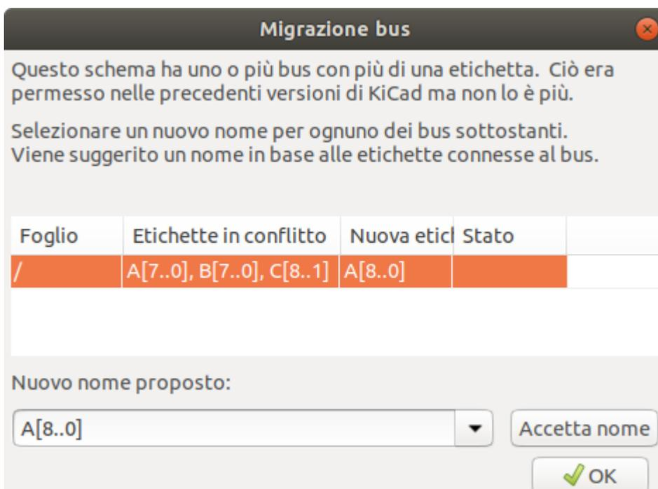
Per ogni insieme di fili di bus che ha più di una etichetta, è necessario scegliere l'etichetta da tenere. Il menu a discesa permette di scegliere tra le etichette che esistono nel progetto, oppure è anche possibile scegliere
